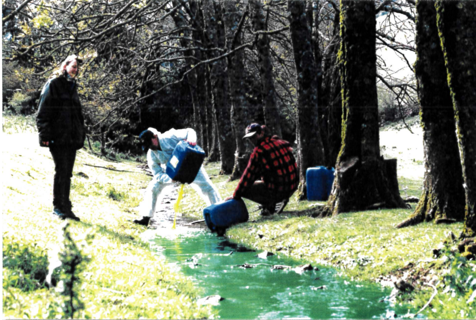
Photo 3 : Injection de la fluorescéine en amont de la perte de Saint Andrieu, le 22/04/2001 à 11h
